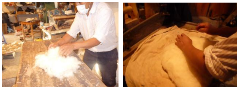
Elaboración de láminas u hojas de lana
