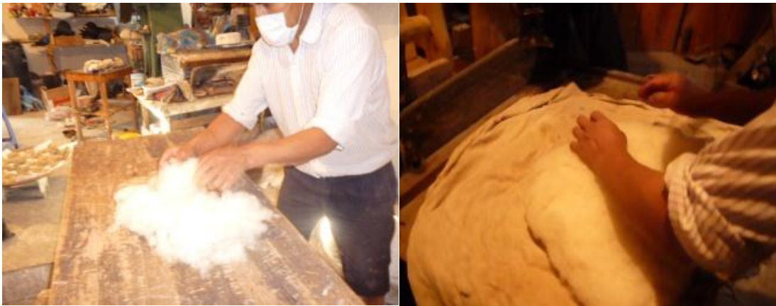
Elaboración de láminas u hojas de lana
