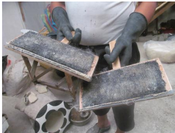
Escarmenado con cardas manuales Fuente: Investigación de campo realizada, Septiembre 2013
