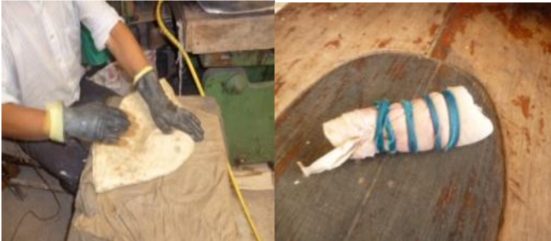
Paño tierno y pulverización del betún
