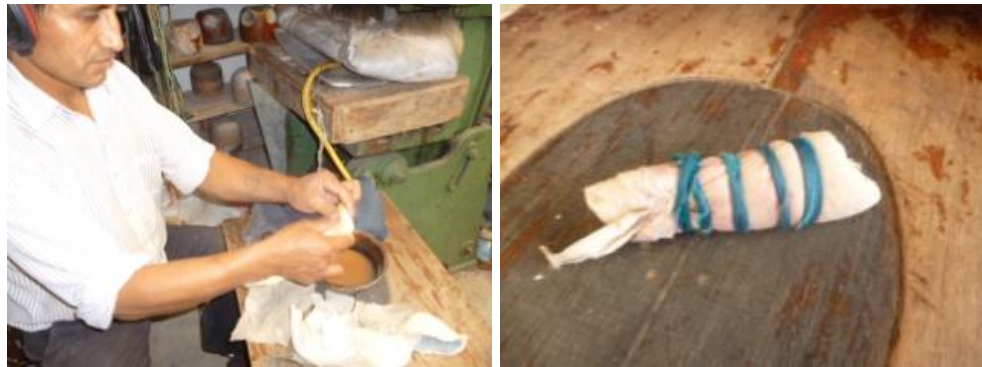
Paño tierno y pulverización del betún
