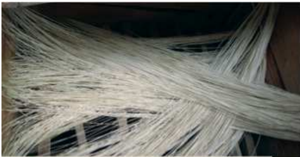
Una vez seca y desprendida la paja previamente hervida, se la coloca en un sahumador (cajón de madera) que contiene un recipiente con carbón y azufre en la parte baja. Este proceso permite blanquear la paja para empezar el tejido
